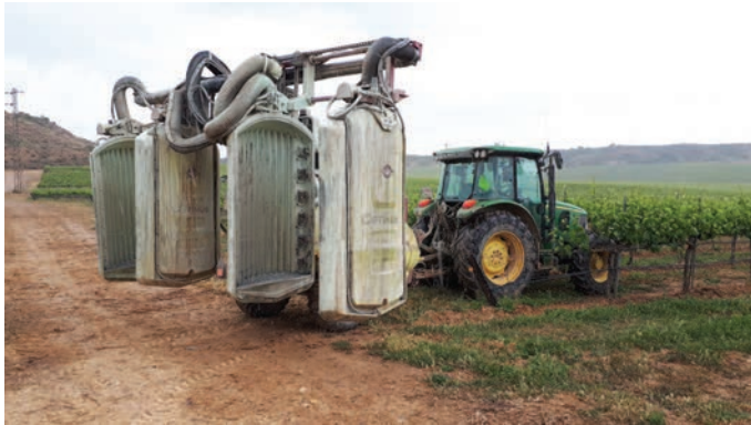
Foto 1. Túnel pulverizador de reciclado Hardi Optimus conformado por cuatro paneles recuperadores verticales, un ventilador de flujo radial y un total de seis boquillas por panel.
