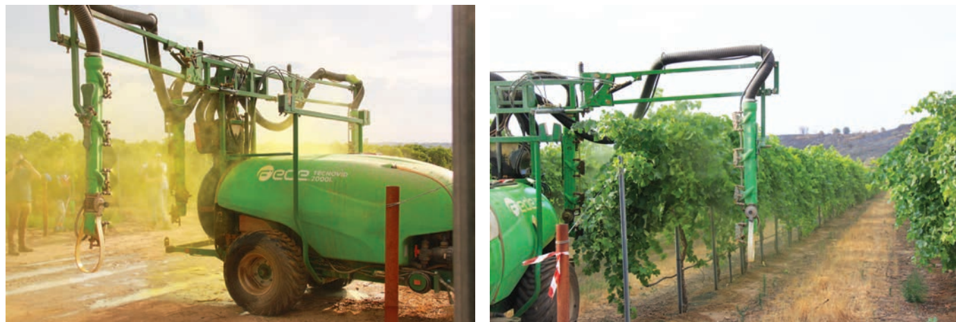
Foto 2. Pulverizador Fede Tecnovid conformado por cuatro bajantes que operan bis a bis sobre la misma fila.
